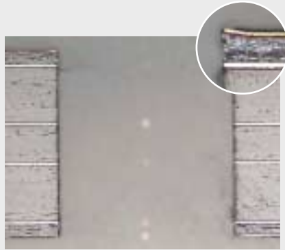
Schnitt durch eine Leiterplatte Bohrloch ungebürstet
